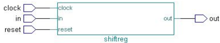
Figura 28. Schema bloc la nivel Top pentru mașina prototip
